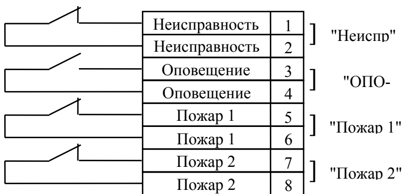
Рисунок 10 - Схема подключения контактов реле прибора ППК-2БМ к коммутационным колодкам
