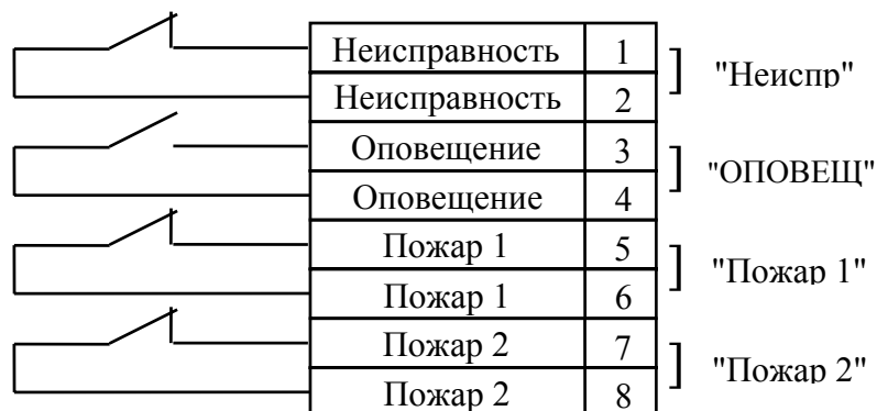
Рисунок 11 - Схема подключения контактов реле прибора ППК-2М к коммутационным колодкам
